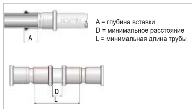
Рис. 27. Глубина вставки и минимальные размеры.
